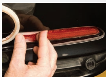
Maskowanie miejsc trudnodostępnych – np. reflektory
