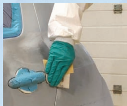
Pozostawiając Piankową Taśmę 3M Soft Edge Foam Masking Tape PLUS i pozostałe zamaskowanie na miejscu
