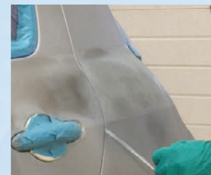
Po naniesieniu podkładu i wygrzaniu, usunąć Taśmę Maskującą 3M Smooth Transition Tape bez otwierania drzwi.
